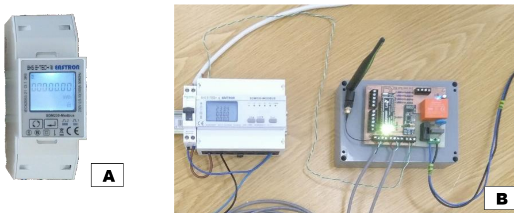
Figura 4.18 – Medidor de energia SDM230 (A). Medidor de energia SDM530 ligado a uma Lopy Power Board V1 (B)
