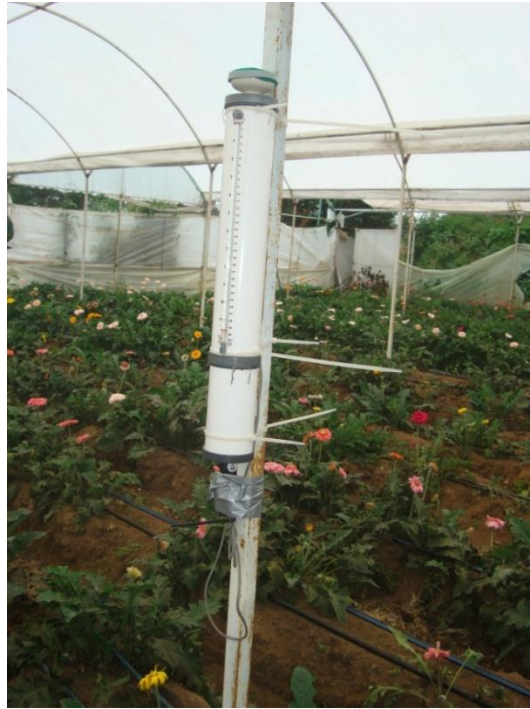
Figura 4.14. Evaporímetro Etagage instalado en el invernadero.
