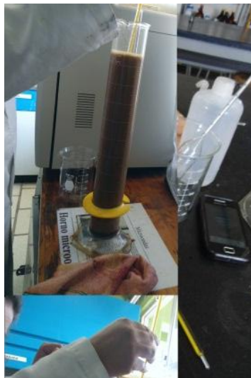
Figura 4.19. Clasificación de material fino por la técnica de Bouyoucos.
