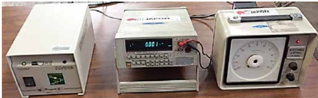
Figura 7. Dispositivos utilizados para el registro de datos. Acondicionador eléctrico, amplificador digital y lector análogo (de izquierda a derecha).
