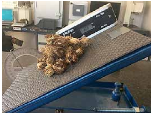
Figura 3. Determinación del ángulo de talud
