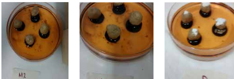
Figura2. Pellets utilizados en la prueba de absorción capilar
