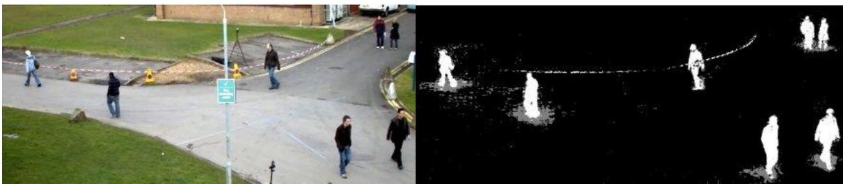
*Figura 3.8 Aplicación de algoritmo Substracción de fondo KNN.*
