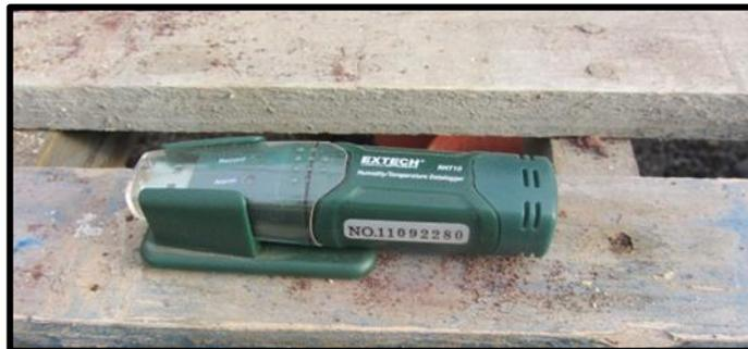
**Figura 7. Data logger para toma de temperaturas y humedad relativa**
