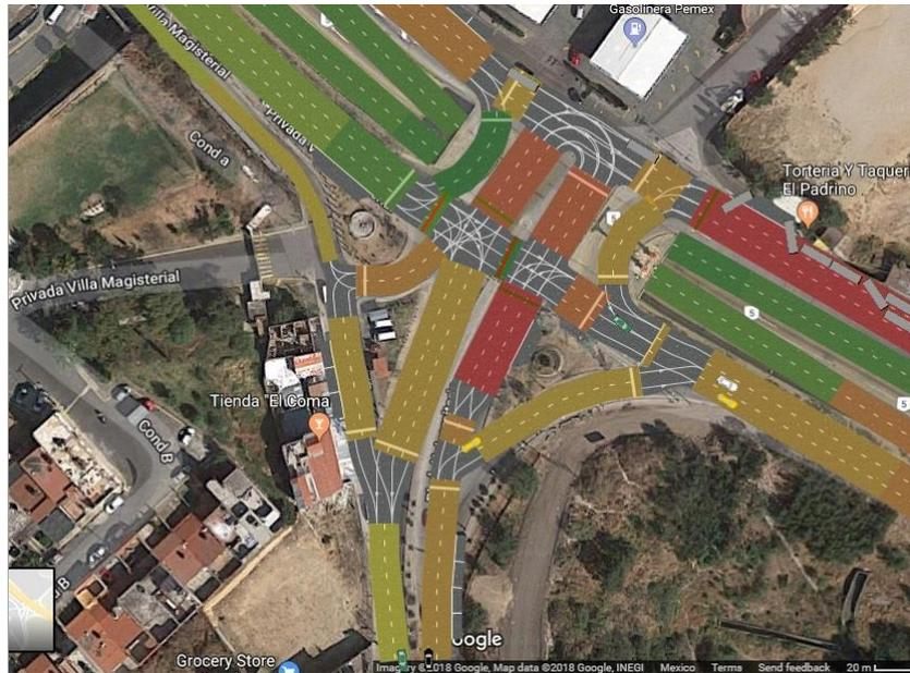
**Figura 4.39** Ejecución 2D del modelo de tráfico vehicular y su mapa de densidad vehicular
