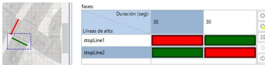
**Figura 4.31** Cambio de color de una fase de semáforo en el editor gráfico
