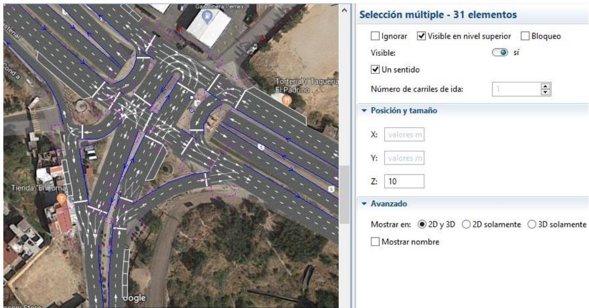
**Figura 4.32** Valor de altura en el eje “Z” para las vialidades
