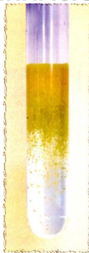
Ilustración 7.4 El nitrato de plomo (II) reacciona con el yoduro de potasio formando un precipitado amarillo.
