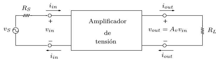
Figura 1.1: Esquema básico de un amplificador de tensión (no se muestra la alimentación).
