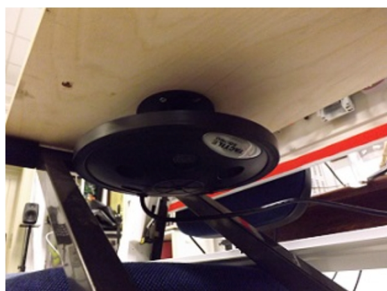
Figura 2. Uno dei due trasduttori utilizzati per erogare vibrazioni alla tastiera.
