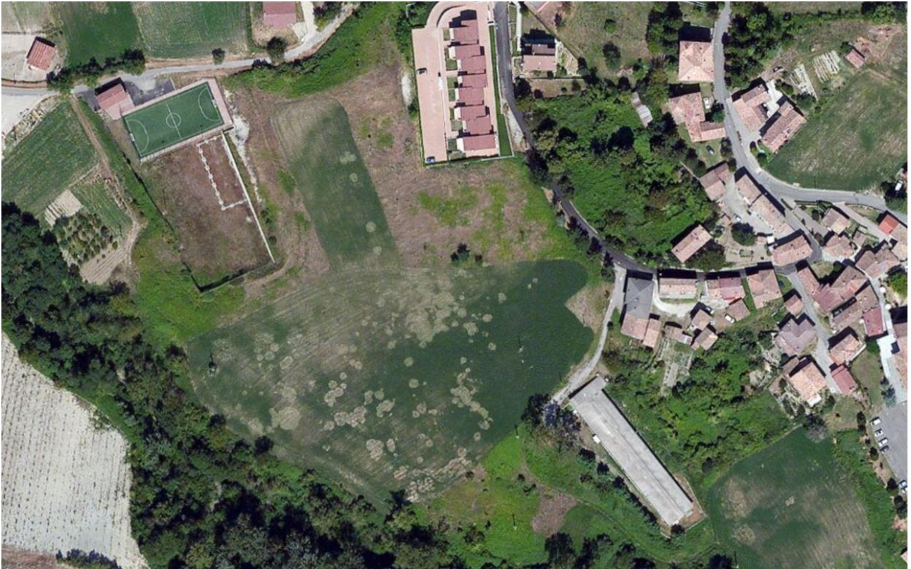
Fig. 6.20 Suffosione in località Sant'Albano.
