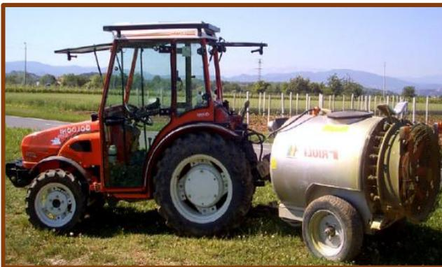
*Fig. 2.11 – Atomizzatore trainato. Gli ugelli posti a ventaglio provvedono alla polverizzazione meccanica della miscela mentre il ventilatore assiale fornisce il flusso d'aria necessario al trasporto delle gocce. Da notare i due deflettori superiori impiegati per cercare di ridurre l'effetto deriva.*
