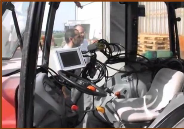
*Fig. 4.12 - Il PC veicolare montato a bordo del trattore durante le prime prove di funzionamento*
