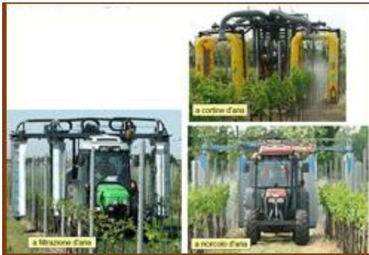
Fig. 2.19 - Irroratrici a tunnel per vigneto con recupero. Evidente la complicazione costruttiva e l'ingombro inutile della macchina specie nella fase precoce del trattamento realizzato nell'ultima figura (fonte: Pergher 2012)
