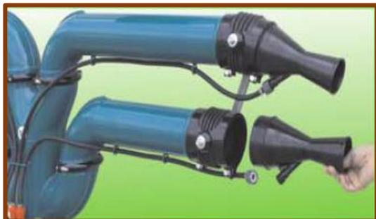
Fig. 2.8 - In evidenza i bocchettoni con la forma a tubo di Venturi per provocare l'accelerazione dell'aria in uscita e il connettore che serve ad alimentare il diffusore della miscela a bassa pressione
