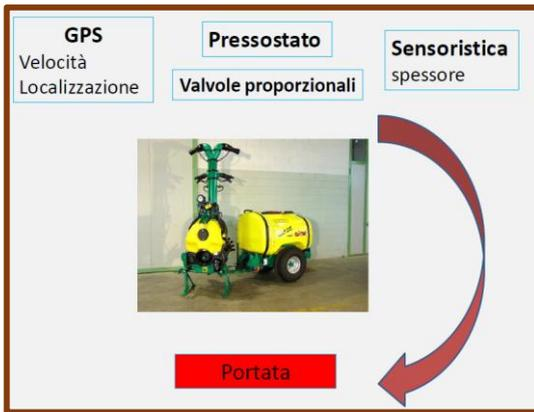
Fig. 4.5 - Schema logico impiegato per collegare i componenti nel sistema di controllo realizzato
