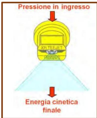
Fig. 2.6 – Modalità di funzionamento degli ugelli a polverizzazione meccanico-idraulica
