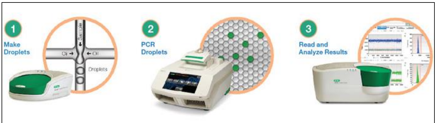
Figura 9: Raffigurazione del “droplet generator” (1), Real-time PCR (2) e “droplet reader” (3).
