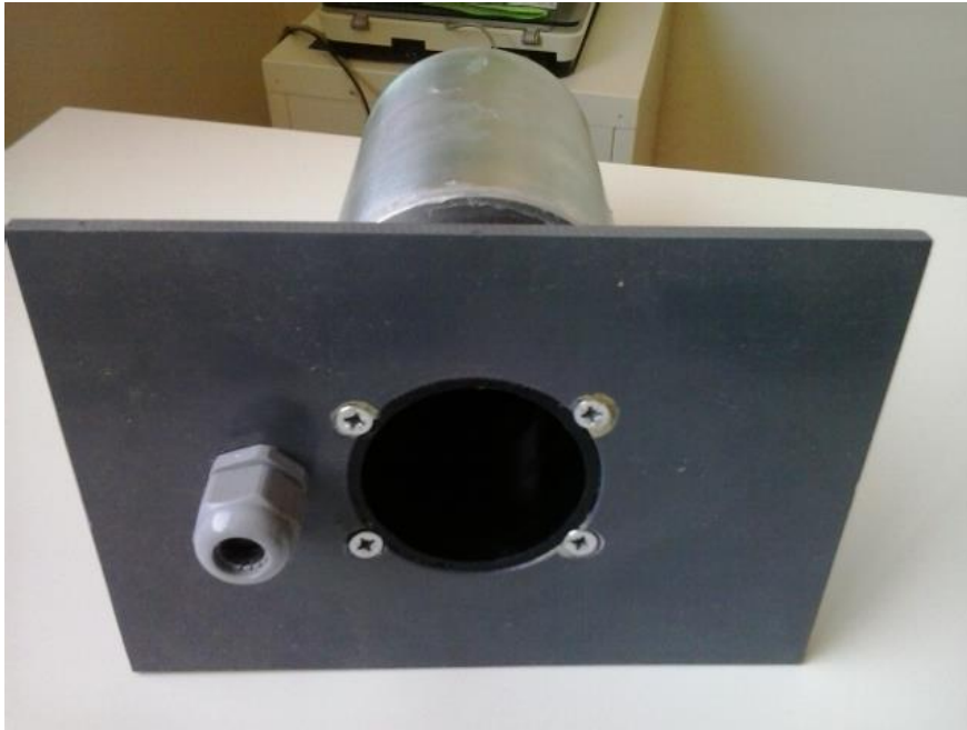
Figura 41: Corpo nero costruito per una prima calibrazione della termopila. La parte immersa nel bagno termico è costituita di alluminio e internamente completamente dipinta di nero. La parte esterna è servita come appoggio per il puntatore, la cui parte sensibile era diretta verso l'interno del bagno termico.
