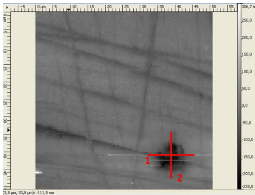
Figura 25: Profili orizzontali e verticali della cavità “intrinseca” della superficie
