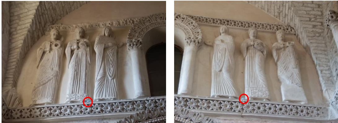
Figura 79: Posizione dei sensori di Temperatura e umidità relativa posti ai piedi delle statue (cerchio rosso).
