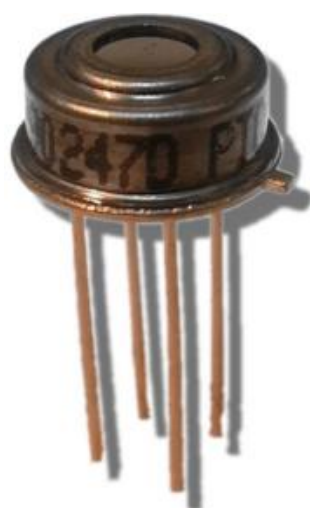
Figura 30: Termopila della Melexis utilizzata.
