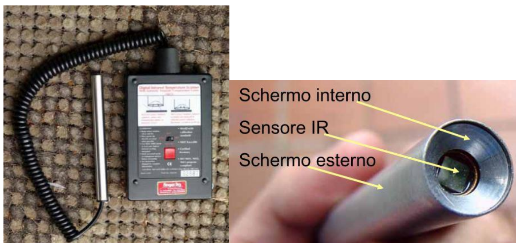
Figura 5: Sensore di quasi- contatto.
