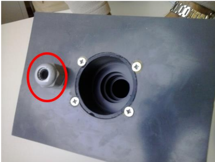
Figura 42: Immagine dall'altro del corpo nero utilizzato per la calibrazione della termopila. Si osserva l'apertura del corpo nero su cui è stato poggiato il puntatore, con la parte sensibile rivolta verso l'interno. La sonda di riferimento è stata posta più vicina possibile al corpo nero, così che le due temperature (corpo nero e sonda di riferimento) avessero una temperatura confrontabile.
