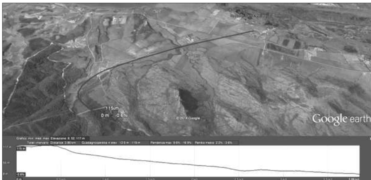
Fig. 31 - Il tracciato indicativo dell'acquedotto di Neapolis ed il suo profilo altimetrico (elaborazione dell'autore da Google earth).
