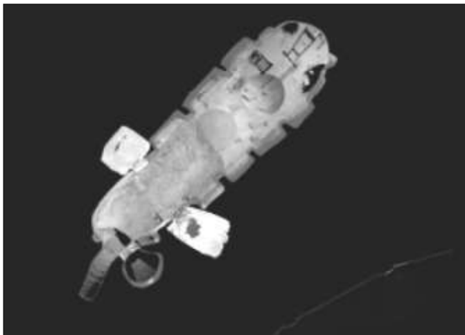
Fig. 17 - Cagliari. Il rilievo tramite laser scanner della grande cisterna sotterranea presso il bastione di Santa Caterina (da CISCI, TATTI 2013, p. 17, Tav. II.2).
