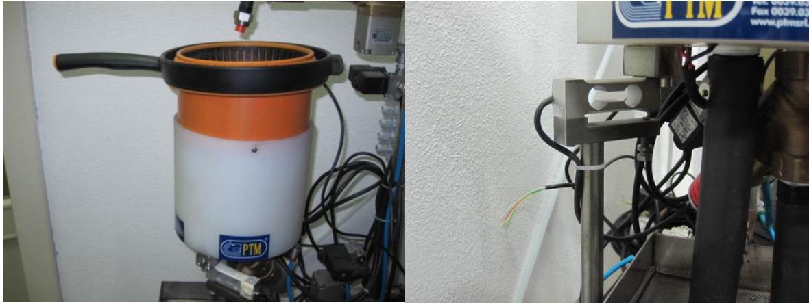
Figura 5.6-2 Primo contenitore e particolare delle celle di carico su cui è poggiato
