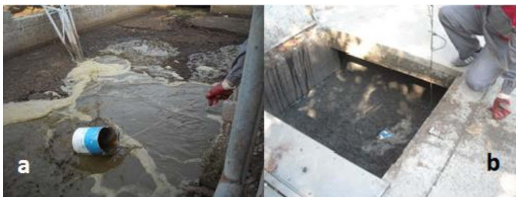
Figura 3.3-1 Campionamento in fossa di raccolta esterna: scoperta e miscelata con trattore, in un allevamento bovino (a) e coperta, e miscelata con secchio, in un allevamento suino (b)
