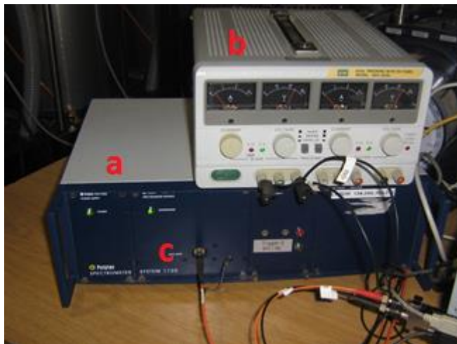
Figura 4.6-3 - spettrofotometro polytec 1720 (a), con alimentatore (b) per la fonte luminosa (lampada alogena) inserita nella testa di misurazione. Il segnale infrarosso captato dalla testa di misura, giunge allo strumento tramite una fibra ottica (c)
