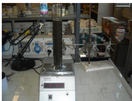
Figura 4.1-4 Misura della densità pesando un cilindro graduato
