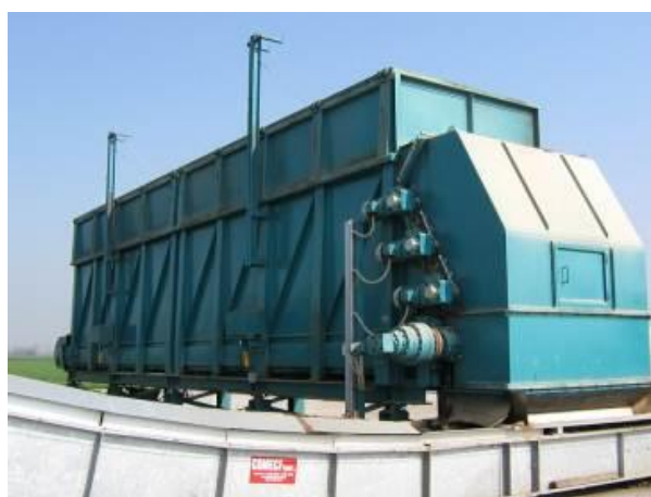
Figura 2.2-2 Tramoggia per il carico delle biomasse solide
