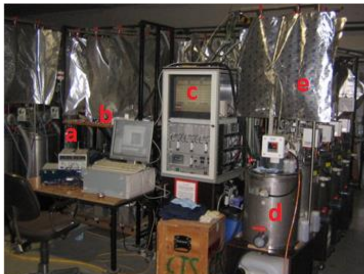
Figura 4.6-2 - Vista dell'impianto pilota utilizzato. partendo da destra: spettrofotometro polytec e alimentatore per la fonte luminosa (a); pc per la gestione delle acquisizioni spettrali (b); pannello di controllo per l'analisi del biogas (c); digestore (d) e sacchetto per la raccolta del biogas (e).
