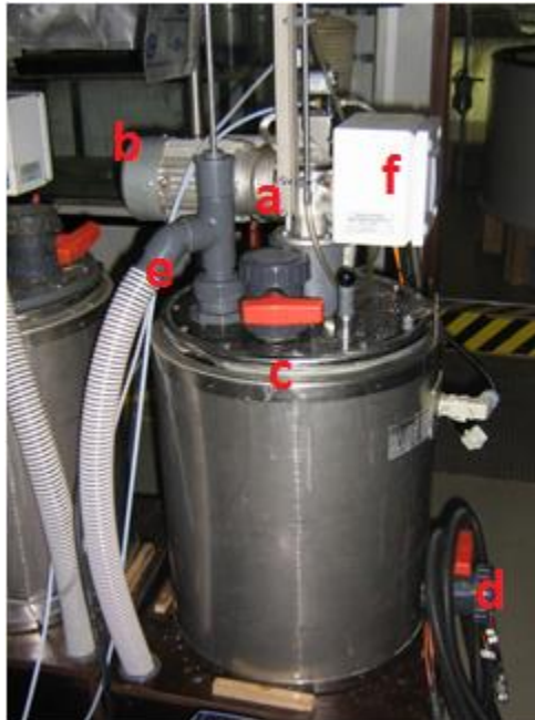
Figura 4.6-1 Il digestore era dotato di miscelatore (a) azionato da motore elettrico (b), valvole di carico (c) e di scarico (d), valvola di sicurezza per lo sfogo del biogas (e), centralina per il controllo della temperatura (f)
