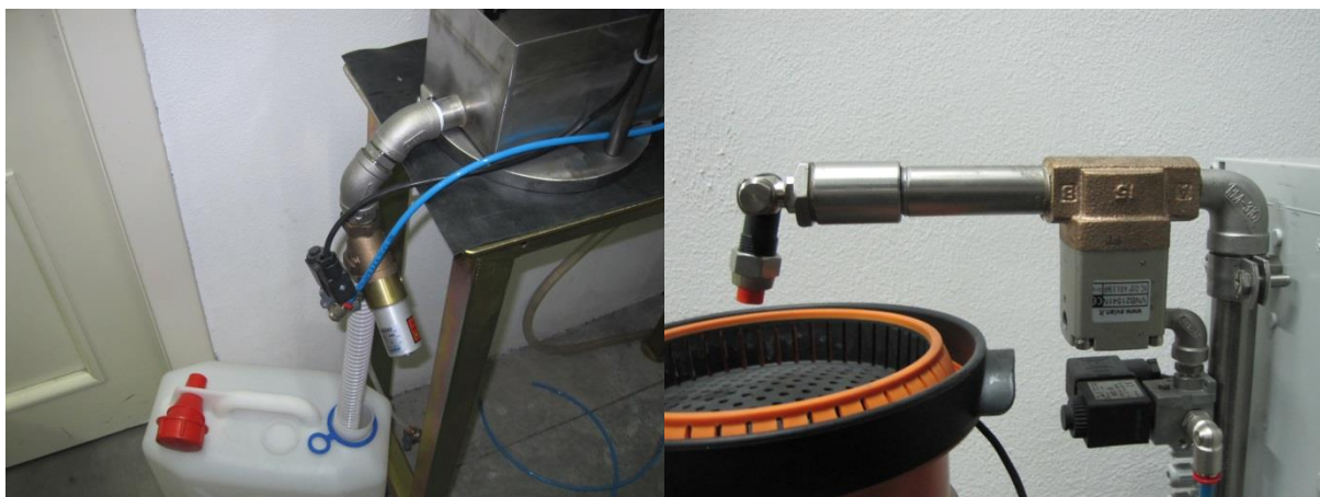
Figura 5.6-4 Particolare dello scarico del secondo contenitore e particolare dell'ugello di lavaggio
