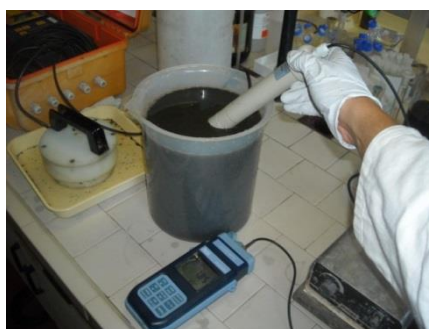
Figura 4.1-3 Misura del pH con pHmetro da campo
