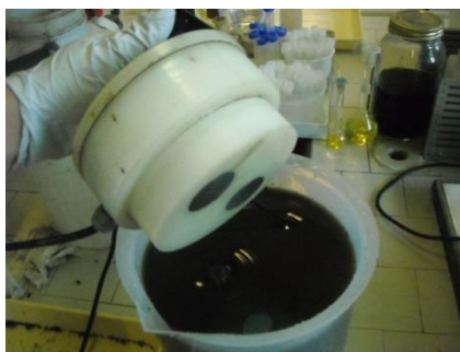
Figura 4.1-1 Misura della conduttività elettrica con sonda PTM
