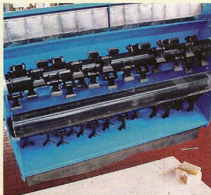
Foto A - Particolari costruttivi dell'operatrice: vista inferiore con il rotore anteriore per la sminuzzatura grossolana, il rullo folle d'appoggio e il rotore posteriore per la sminuzzatura fine dei residui
