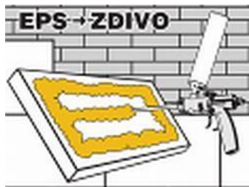
Obrázek 33 Nanášení lepicí pěny na izolační desku [37]
