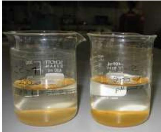
Foto 7 Muestras del agua neutralizadas por método químico con lechada de cal al 10%
