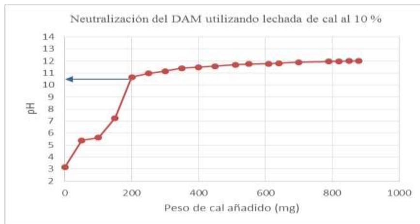
Figura 5. Neutralización del DAM con lechada de cal al 10%
