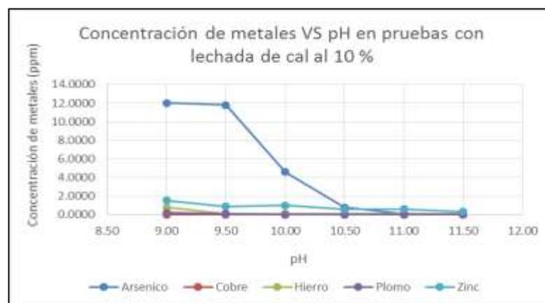
Figura 6. Concentración final de metales después del tratamiento con lechada de cal al 10%
