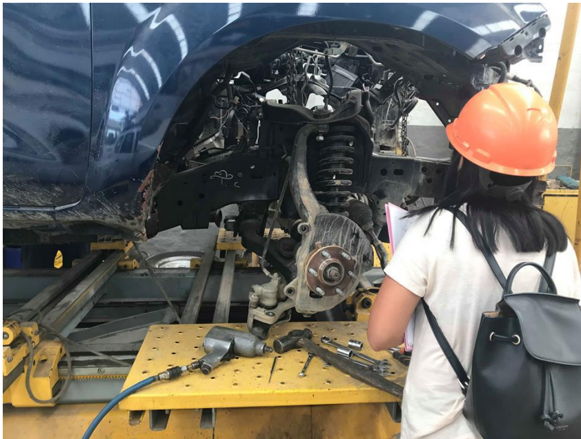
Figura 85. Control de cumplimiento en el proceso de Traccionamiento
