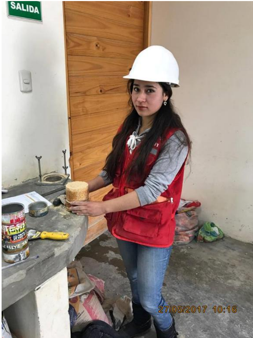
Imagen 29. Realización del ensayo de Proctor Modificado con adición de fibra.
