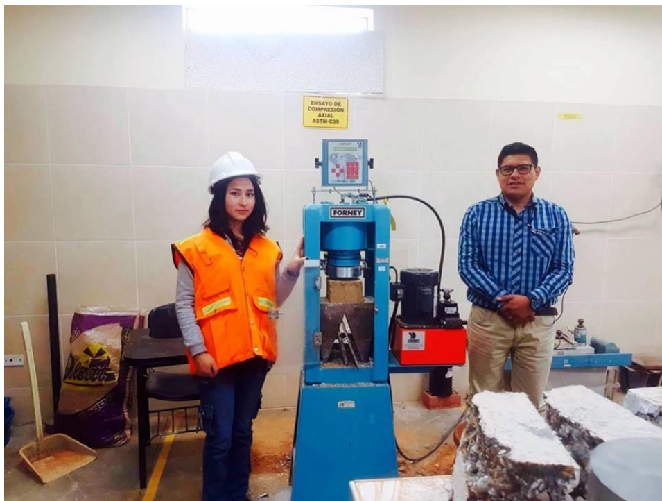
Imagen 41. Ensayo de resistencia de compresión axial de muestra patrón de adobe compactado.
