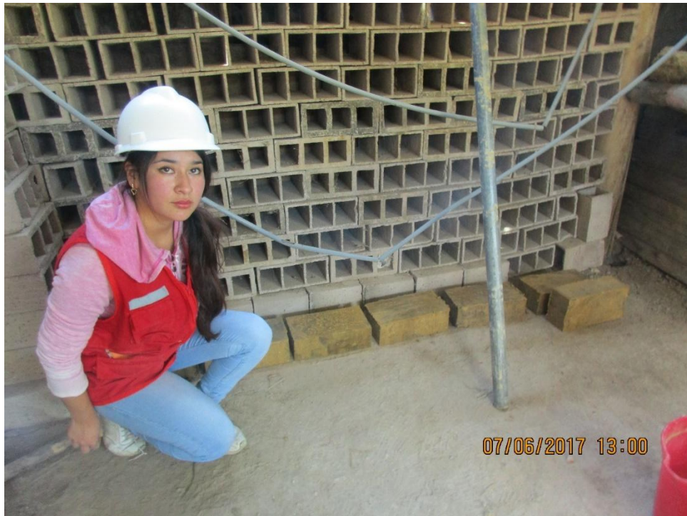
Imagen 34. Elaboración de muestras patrón de adobe compactado.
