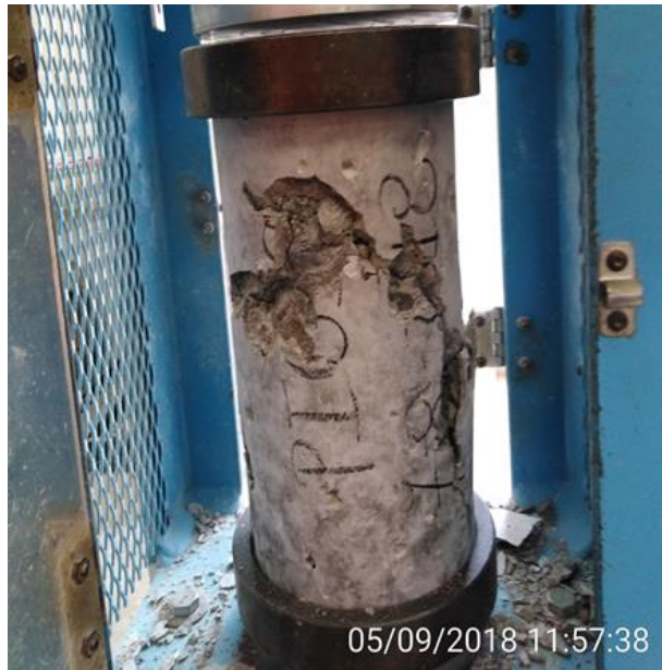
28. Falla de probetas
