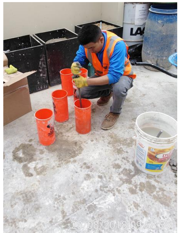
21. Peso recipiente vacío para determinar la densidad, rendimiento y contenido de aire.
