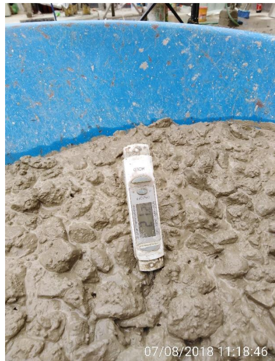
19. Ensayo de temperatura
