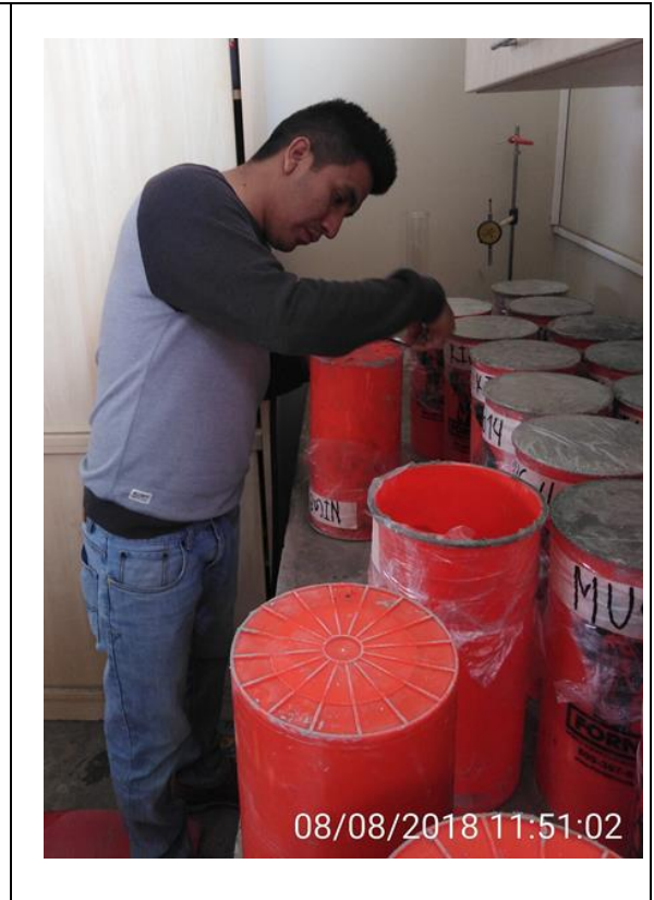
25. Desencofrado de probetas
