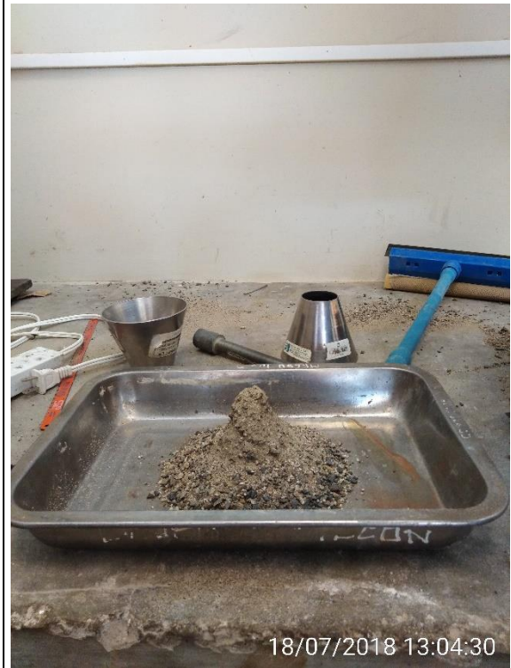
9. Levantamiento del molde conico
