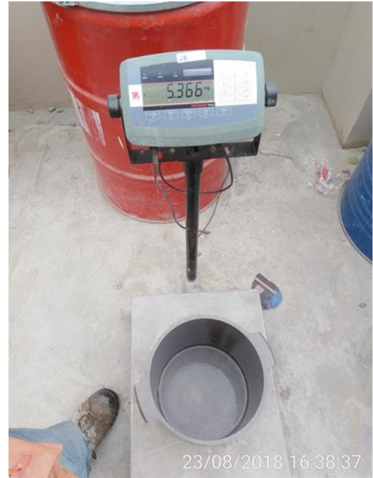
21. Peso recipiente vacío para determinar la densidad, rendimiento y contenido de aire.
