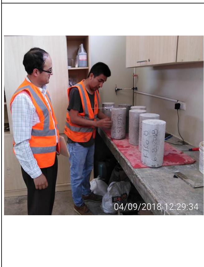
26. Medición de diámetro de la probeta
