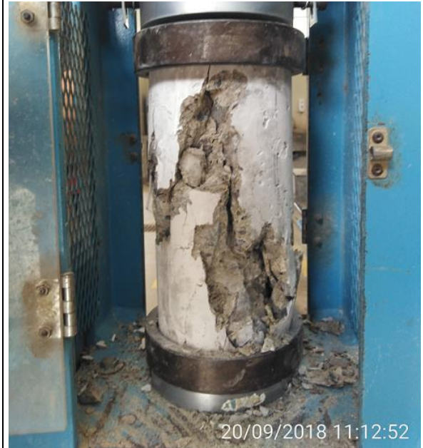
29. Falla de probetas
