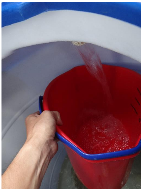
Figura 37. Determinação da vazão pelo método direto
