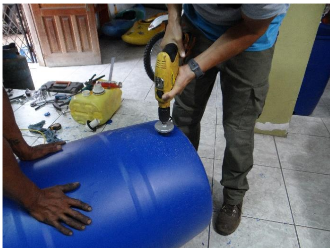
Figura 19a. Perfuração dos tanques de PVC
