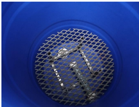
Figura 24d. Colocação do suporte do leito filtrante
