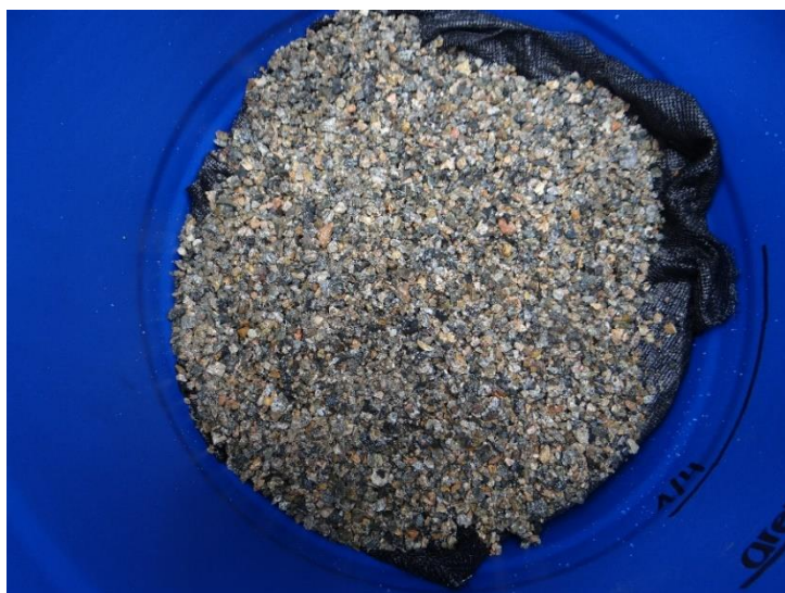
Figura 28. Separação das camas filtrantes por tela geotêxtil
