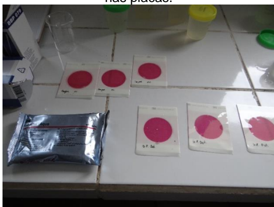
Figura 13a. Colocação das amostras de água nas placas.
