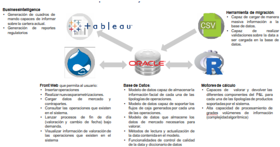
Ilustración 29 Módulos del sistema futuro
