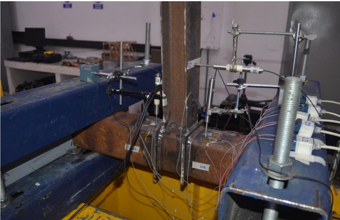
Imagen 6. Montaje del ensayo para la conexión. Imagen propia
