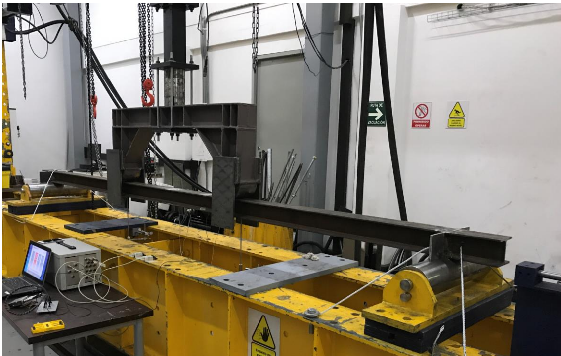
Imagen 4. Montaje del ensayo para la viga HEA100. Imagen propia
