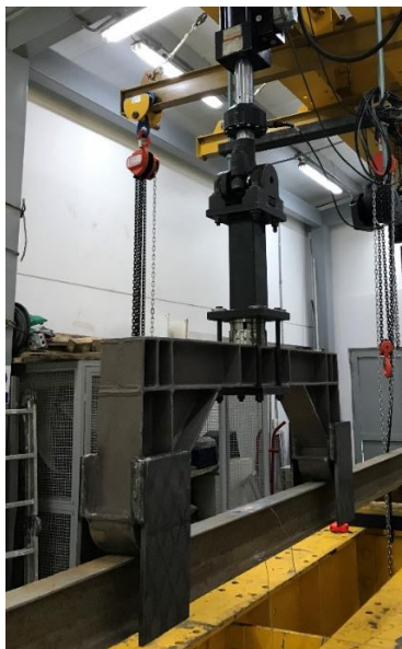
Imagen 7. Actuador hidráulico de 100kN de capacidad junto con el aplicador de carga a los tercios de la luz de la viga para simular ensayo a flexión pura. Imagen propia
