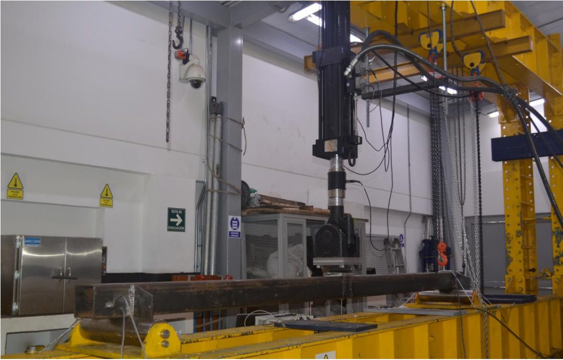
Imagen 5. Montaje del ensayo para el perfil PTE. Imagen propia
