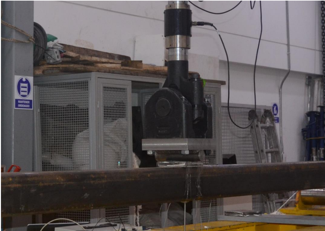
Imagen 8. Actuador de 250kN dispuesto para ensayo de PTE. Imagen propia
