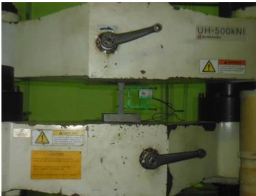
Imagen 3. Foto del montaje de una de las probetas en la máquina universal de ensayos. Imagen propia
