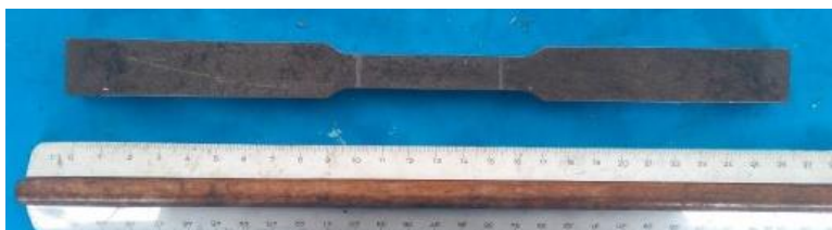
Figura 45. Muestra obtenida del mecanizado del acero dispuesto para la placa de continuidad acorde con la norma ASTM E8. Imagen propia
