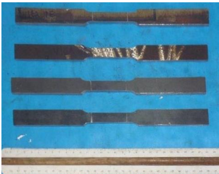
Figura 44. Muestras obtenidas del mecanizado de los perfiles acorde con la norma ASTM E8. De arriba hacia abajo, Perfil PTE 9mm pieza 1, Perfil PTE 9mm pieza 2, Perfil HEA alma 5mm, Perfil HEA aleta 7.4mm. Imagen propia.
