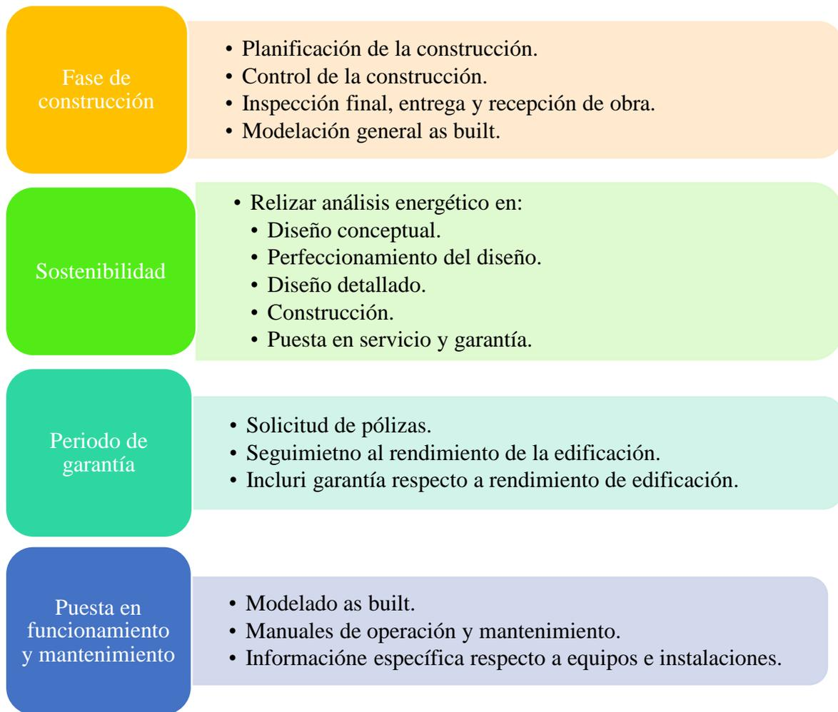
*Figura 37. Resumen generación y uso del modelo BIM en las diferentes etapas del proyecto (parte 2)*
