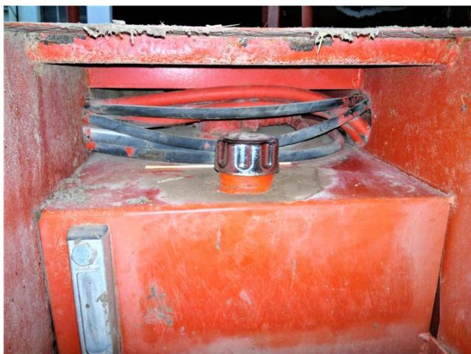
**Figura 53 – Reservatório de óleo com o respectivo bujão de enchimento e visor de nível**
