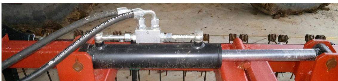
Figura 22 - Cilindro hidráulico de duplo efeito: haste (*piston rod*); êmbolo e vedantes (*piston & seals*); porta (*flow port*)
