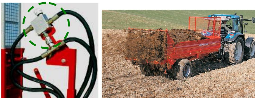
Figura 47 - Válvula de regulação de caudal inserida no circuito de um motor hidráulico (não visível), a qual permite variar a velocidade de translação do fundo móvel de um semi-reboque distribuidor de estrume, possibilitando, assim, regular a densidade de distribuição do estrume (ton/ha).
