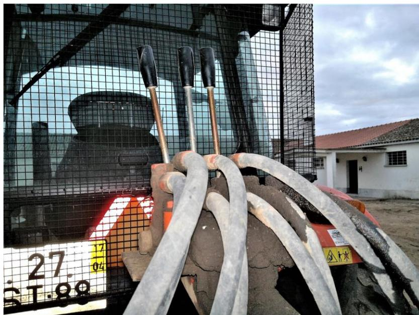
**Figura 54 – bloco com 3 válvulas direccionais e respectivas alavancas de comando**
