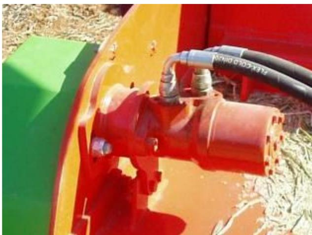
Figura 37 - Motor hidráulico de accionamento de órgãos activos de uma trituradora de rama de poda
