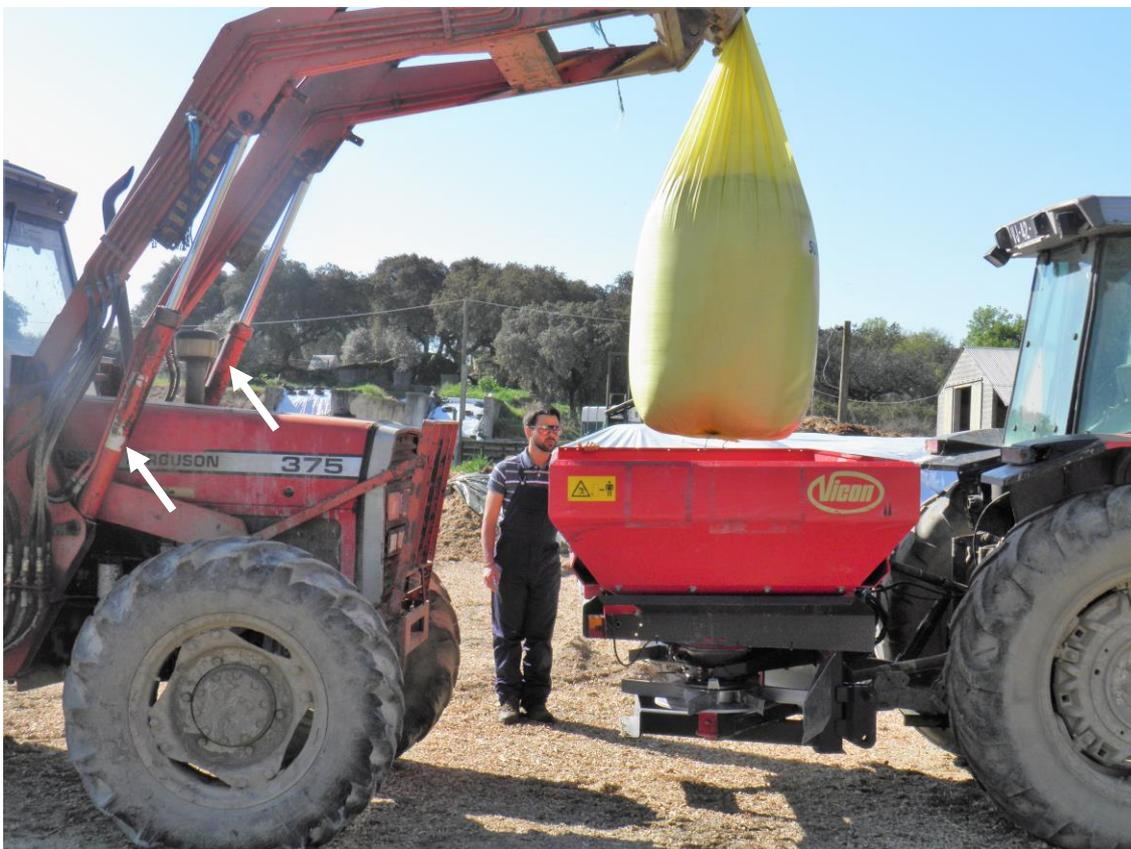
**Figura 35 - Um par de CHDE actuados em paralelo rebate a lança do carregador frontal. Para o mesmo caudal, os CHDE encolhem mais depressa do que estende; para uma mesma pressão, os**
