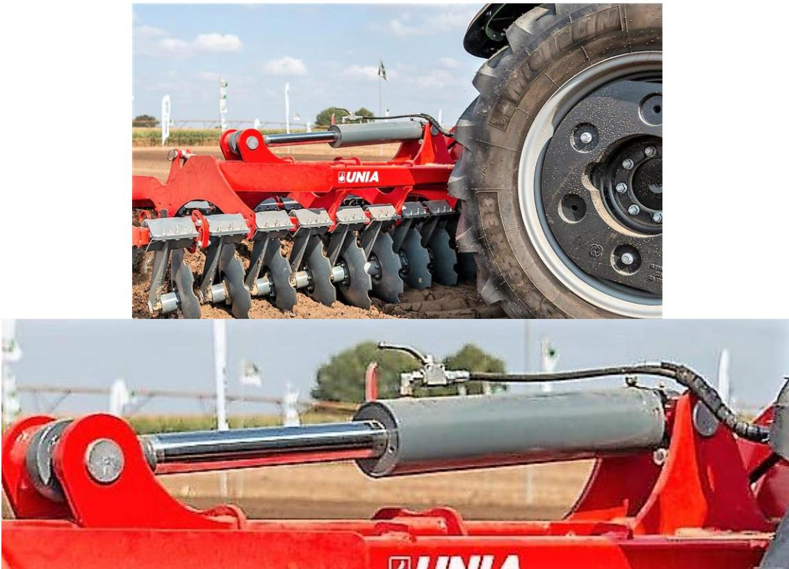
**Figura 24 - Cilindro hidráulico de duplo efeito usado no rebatimento dos corpos para transporte**
