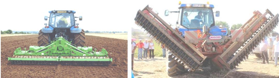
Figura 27 - Dois CHDE em paralelo rebatem os corpos da grade rotativa para a posição de transporte
