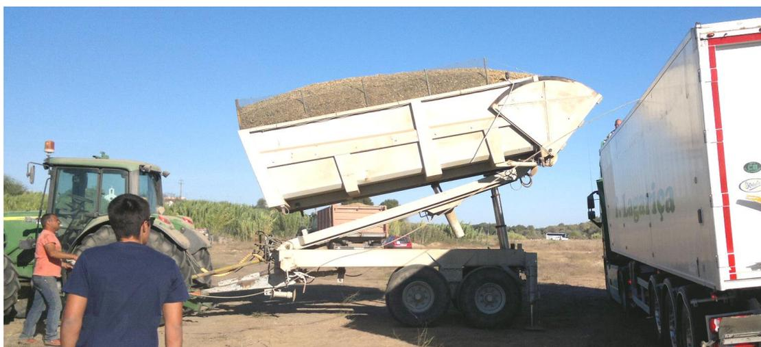
**Figura 60 - Semi-reboque basculante de transbordo descarregando amendoim para veículo de transporte. A imagem mostra a actuação dos cilindros hidráulicos, actuados em paralelo, de levantamento da base da caixa. Visita para observação de colheita de amendoim (Couço) no âmbito da u.c. de Tractores e Equipamentos Automotrizes 2017.**
