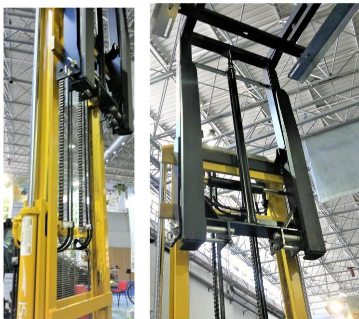
Figura 48 – Elevador de paletes possibilitando a elevação em dois estágios, através de CHDE independentes
