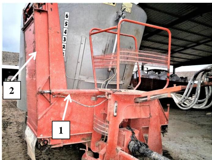
**Figura 56 – CHDE (1) para colocação na posição de trabalho ou de transporte tapete transportador de distribuição (2)**
