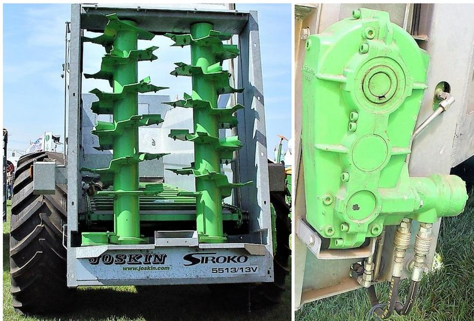
Figura 38 - Motor hidráulico de accionamento (via redutor de engrenagens) do fundo móvel (tapete transportador) do semi-reboque de espalhamento de estrume
