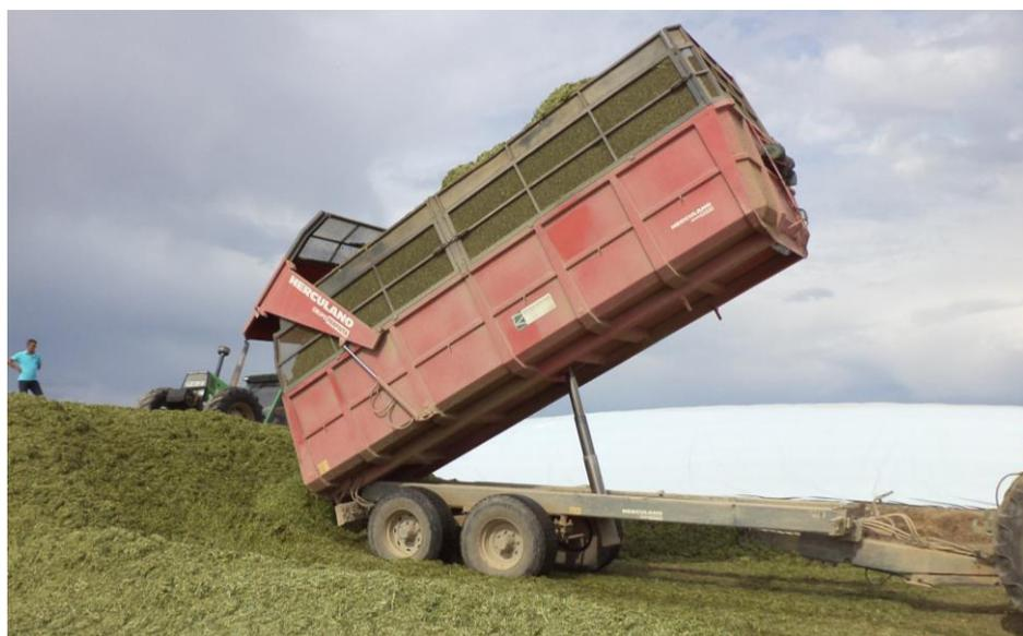
Figura 32 - O semi-reboque (*farm trailer*) da figura dispõe de um CHSE para rebater (*tip*) a caixa; O peso da caixa fará recolher a haste do cilindro.
