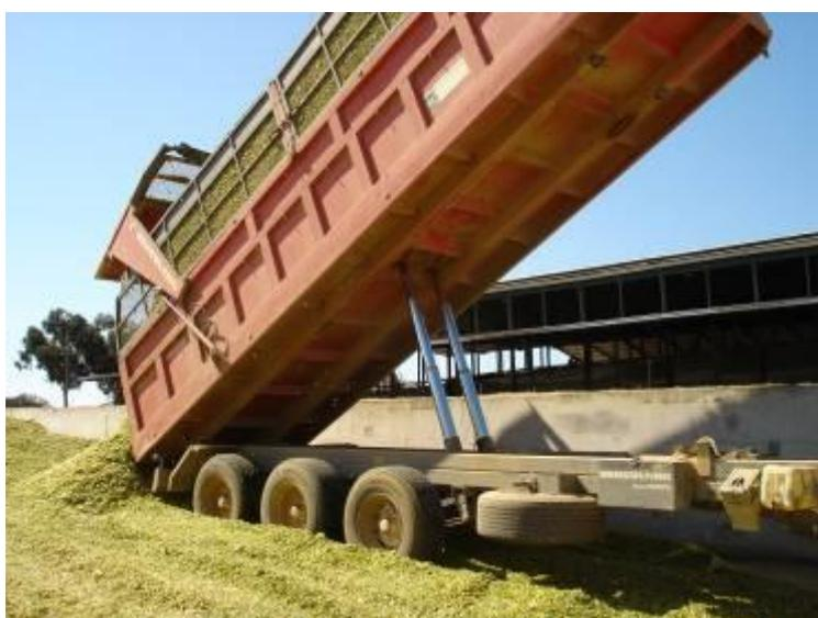
Figura 34 - Semi-reboque basculante com caixa rebatida por dois cilindros hidráulicos de simples efeito (CHSE), em paralelo. Tractores e Equipamentos Automotrizes 2011/12 – Visita à herdade dos Padres
