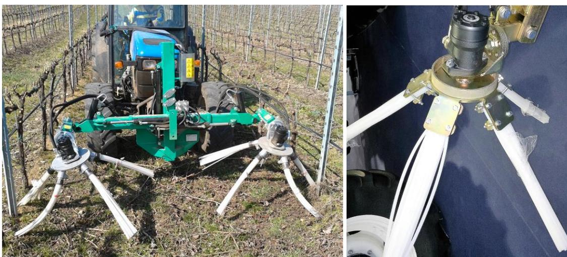
Figura 39 - Motor hidráulico de accionamento das vassouras de uma máquina de encordoar restos de poda
