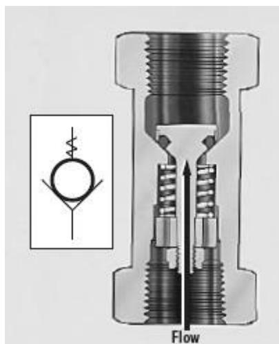
Figura 42 - Válvula de retenção <http://www.hydraulicspneumatics.com/>
