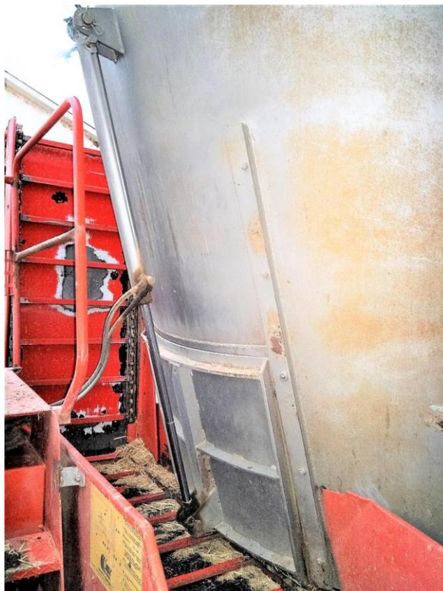
**Figura 55 – CHDE para deslizamento da porta da janela de distribuição**
