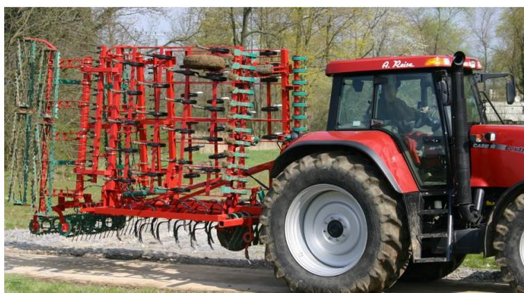
Figura 28 - Os dois cilindros hidráulicos assinalados, actuados em paralelo, rebatem o corpo do lado esquerdo do vibrocultor. Um segundo par de CHDE actuados em paralelo rebate o corpo direito <http://kvernelandgroup.papirfly.no>
