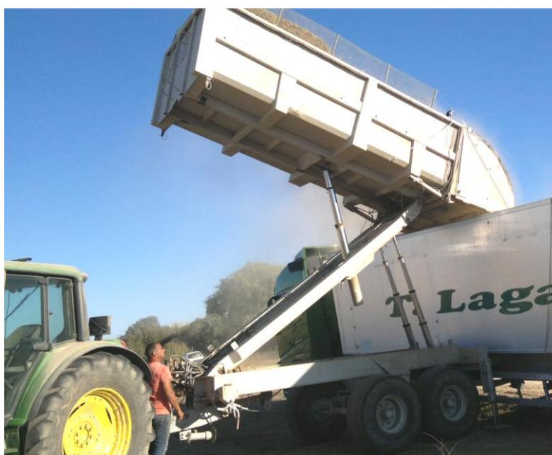
**Figura 61 - Semi-reboque basculante de transbordo descarregando amendoim para veículo de transporte. A imagem mostra a actuação do cilindro hidráulico de rebatimento da caixa. Visita para observação de colheita de amendoim (Couço) no âmbito da u.c. de Tractores e Equipamentos Automotrizes 2017.**
