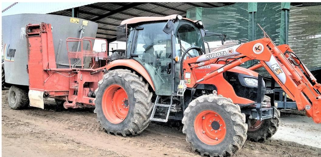
**Figura 51 – Semi-reboque misturador e distribuidor de ração (*mix feeders*) são exemplos frequentes de equipamentos com sistema hidráulico autónomo**
