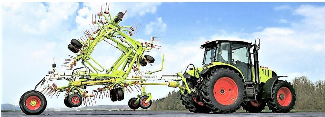
Figura 29 - O virador de feno (*trailed tedder*) da figura, possui um CHDE para actuar as rodas de transporte (*transport wheels*) e CHDE(s), em paralelo, para o rebatimento dos corpos laterais (*folding wings*). [www.claas.com](http://www.claas.com)
