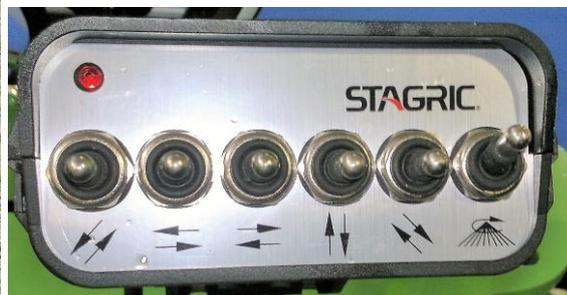
**Figura 44 - Comando do bloco de válvulas (electroválvulas) da máquina de encordoar vides**
