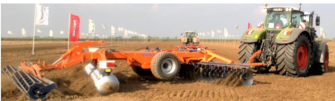
Figura 30 – A grade de discos (*trailed disc harrow*) da figura, possui dois CHDE, em paralelo, para actuar as rodas de transporte (*transport wheels*).
