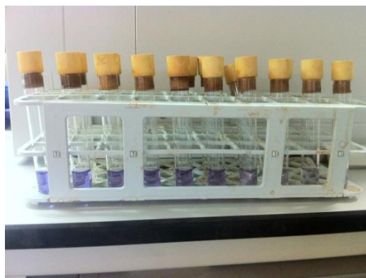
Figura 35 – Tubos de ensaio em que se observa a coloração púrpura devida à formação do corante azóico.
