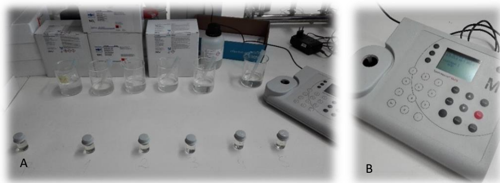
Figura 9 – A. Quantificação das concentrações de nutrientes (amónia, nitritos e nitratos) para cada amostra; B. Fotómetro de bancada ( Spectroquant Multy Colimeter ).
