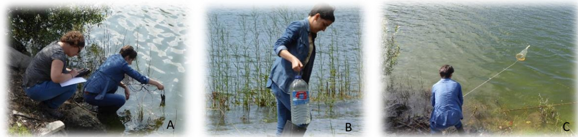
Figura 7 – A. Medição de parâmetros físico-químicos in situ com o auxílio de uma sonda multiparamétrica; B Recolha de uma amostra de água para posterior análise de parâmetros físicos e -químicos e biológica em laboratório; C. Recolha de zooplâncton com rede de arrasto com malha de 250 \mu\text{m} .
