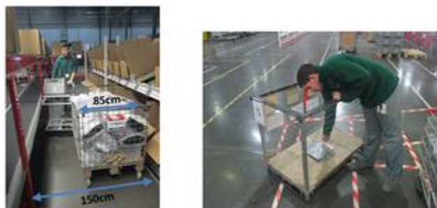
Figura 33: Problemas com os carrinhos abastecedores (à esquerda, um carrinho abastecedor a impedir a passagem de um carro transportador de containers ; à direita, operador com dificuldade em alcançar produto do carrinho)
