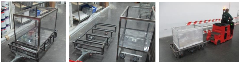
Figura 61: Protótipo de atrelado para mizusumashi
