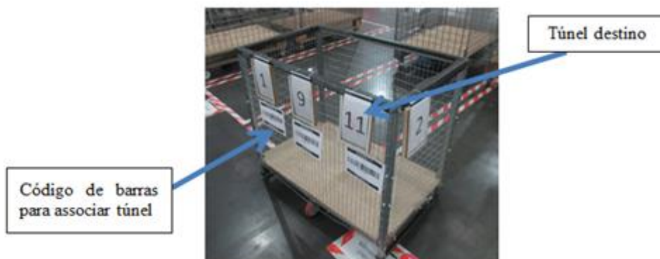
Figura 47: Carrinho com sistema de 3 códigos de barra
