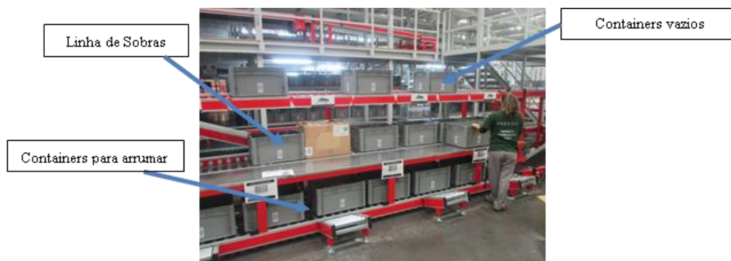
Figura 27: Postos de trabalho - Tratamento de sobras
