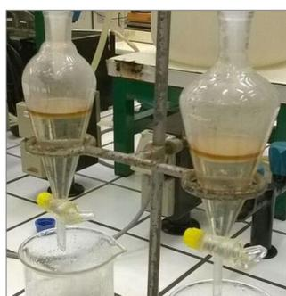
*Figura 18: Separação de fases por decantação.*
