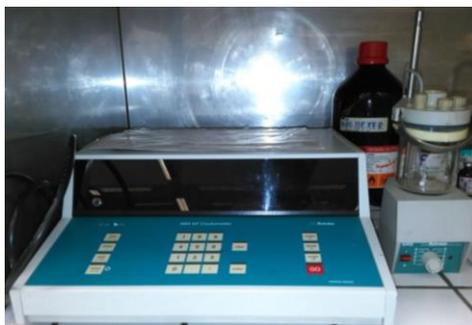
Figura 15: Equipamento usado para determinação do teor de água.
