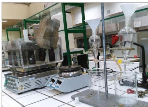
*Figura 19: Montagem experimental do reator e dos funis de decantação.*
