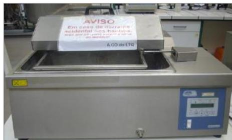
*Figura 17: Banho termostático usado para a realização da esterificação ácida.*
