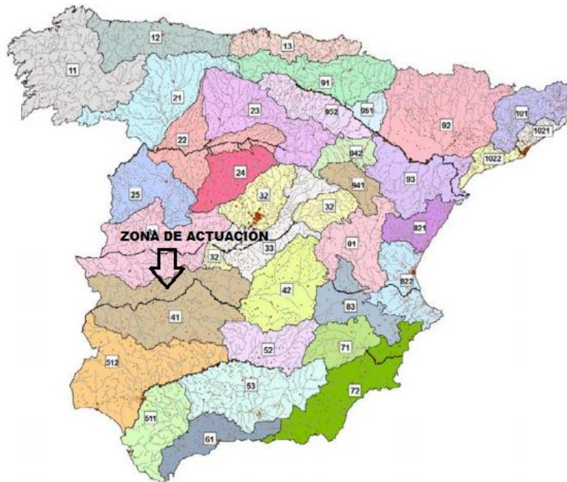
Imagen 9: Regiones consideradas para la caracterización del coeficiente corrector del umbral de escorrentía. Fuente: Norma 5.2 I-C
