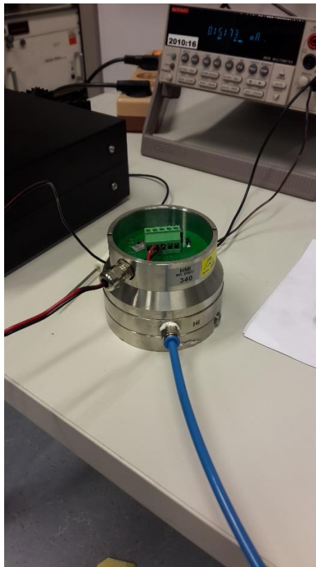
Slika 26. Pretvornik tlaka GE Druck.
