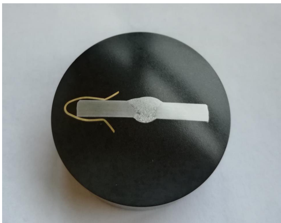
Slika 24. Metalografski uzorak nakon nagrivanja
