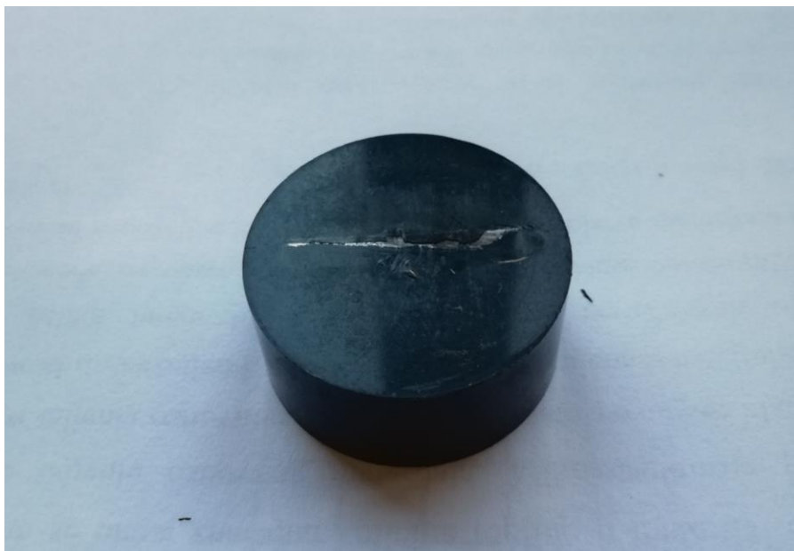
Slika 19. Metalografski uzorak nakon zalijevanja u polimernu masu
