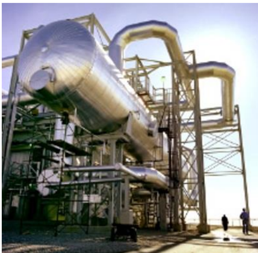
Slika 6. Kotao od dupleks čelika [8]
