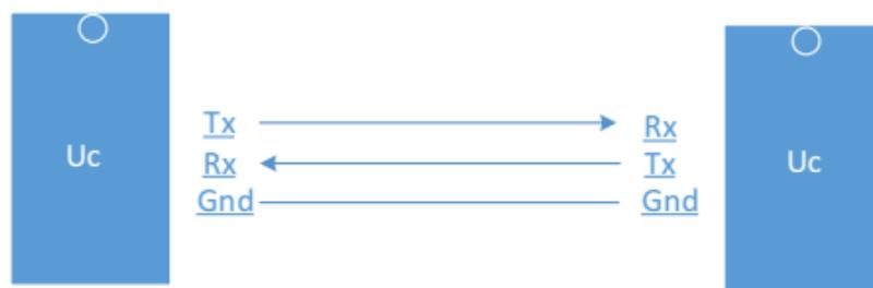
Gambar 9. Komunikasi Serial antar Mikrokontroler
