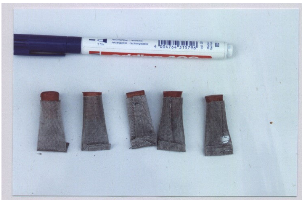
Figura 4.3. Modelos de tubos utilizados para exponer garrapatas ingurgitadas a condiciones de campo.
