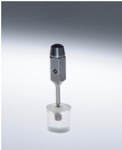
Abb. 13: In PMMA eingebettete Madenschraube mit aufgesetztem Schraubendreher
