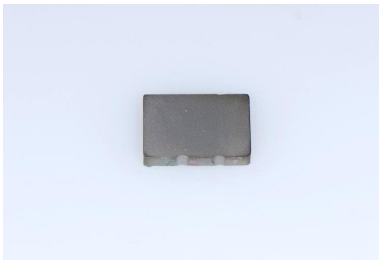
Abb. 21: Probe nach Sputterung mit Gold-Palladium
