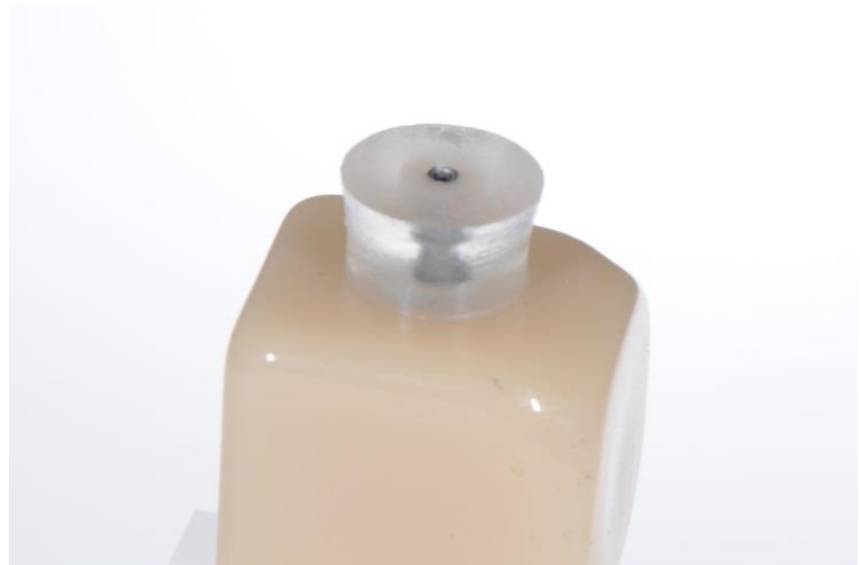
Abb. 14: Rohling mit adhäsiv befestigten Kunststoffblock
