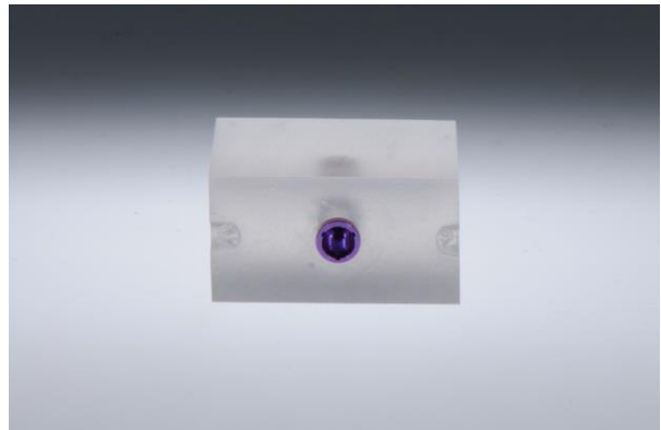
Abb. 9: Kunststoffquader mit eingebettetem Implantat
