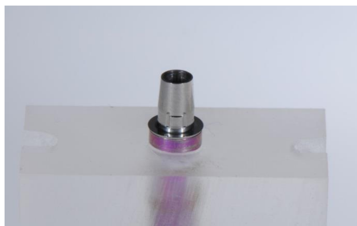
Abb. 10: Kunststoffblock mit eingebettetem Implantat und aufgeschraubter Titanklebebasis
