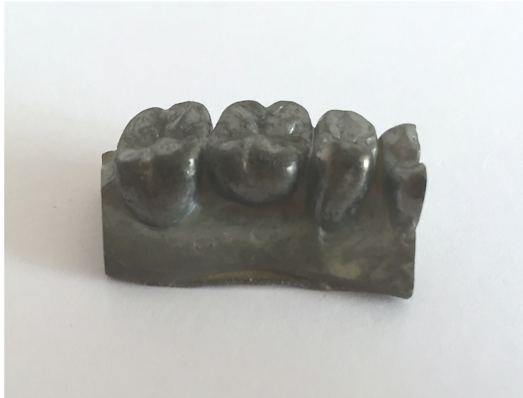
Abbildung 7: Mithilfe Sputteranlage beschichtete Probe
