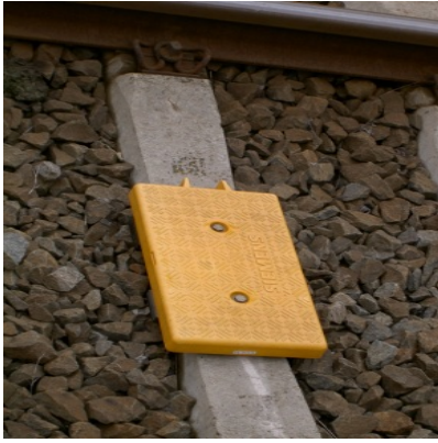
Figure 2.7.: A Siemens Eurobalise in Germany (Gemaakt, 2004)
