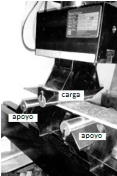
**Fig. 3.** Ensayo de flexión estática.
