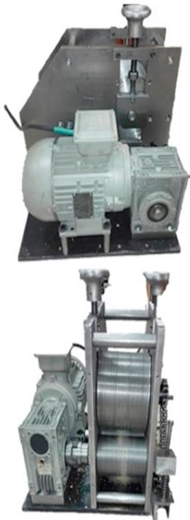
**Fig. 1.** Sistema de trituración empleado para la obtención de fibras.
