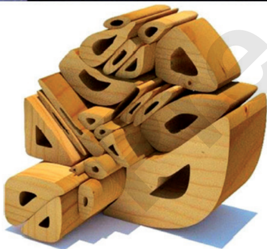
Imágenes 10-12. Curvas de nivel para plantillas de corte. Proceso de corte computarizado y modelo final de prueba, ensamblado.
