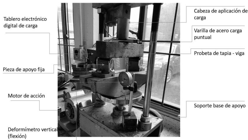
Fig. 12. Grafica de del ensayo para obtener el módulo de rotura con probeta de tapia simple. Fuente: Autores.
