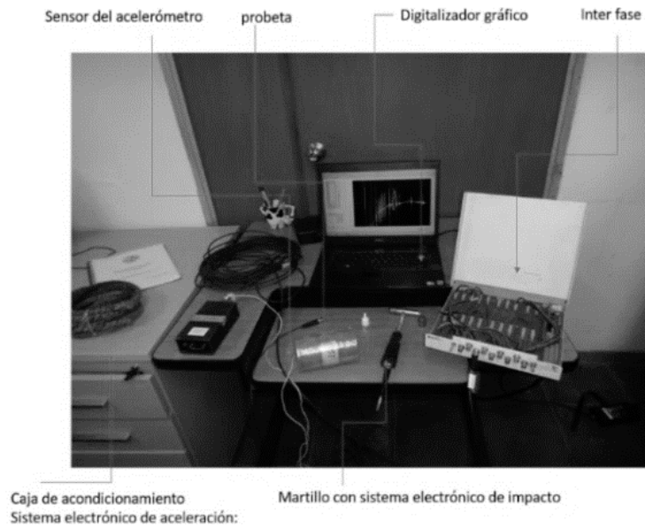
Fig. 9 Sistema para medición de vibraciones libres de un espécimen de la muestra, tapia. Fuente: Autores.
