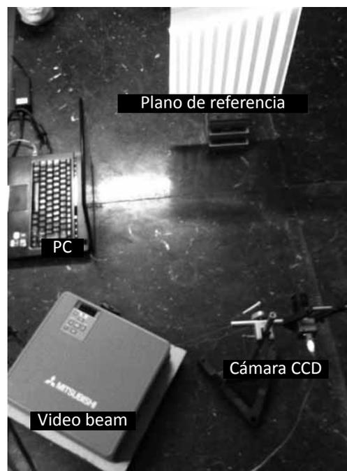
Fig. 5 Montaje experimental de proyección de franjas
