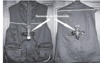
Fig. 3. Chaleco con sensores.
