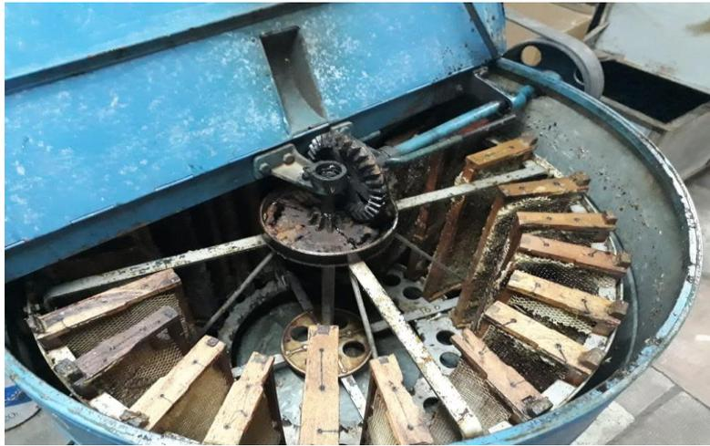
**Figura 10:** Centrífuga para extracción de miel de 18 marcos.
