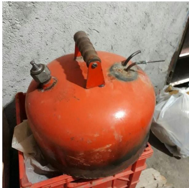
**Figura 12:** Caldera a vapor que provee la temperatura adecuada al cuchillo desoperculador.
