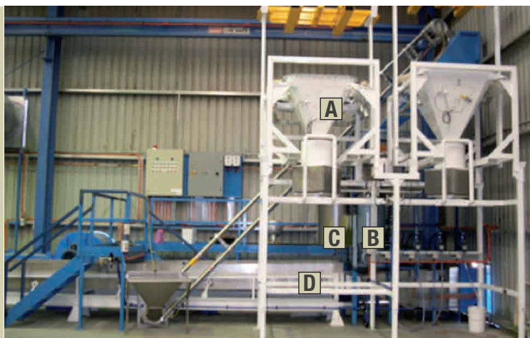
Figura 5: Vista general de equipamiento utilizado para peletear y/ o incrustar semillas. A: Tolva de inicio del circuito. B: Tanque con polímero adherente. C: Recipiente giratorio (Bach) para integrar los componentes del incrustado a las semillas. D: Salida hacia secadora.
