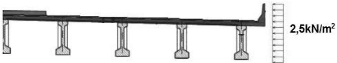
**Figura 3.10** Acción del viento para el puente descargado
