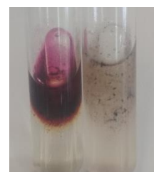
Figura 9. Prueba de reducción de nitratos y nitritos negativa (izquierda) y positiva (derecha).
