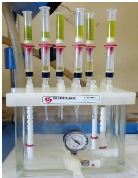
Figura 6. Proceso de limpieza de las muestras y purificación de las toxinas mediante extracción en fase sólida con un sistema dual de cartuchos
