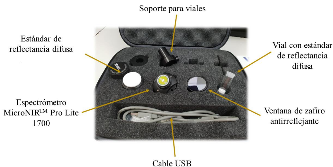
Figura 17. Espectrómetro MicroNIR Pro Lite 1700 y accesorios de medida
