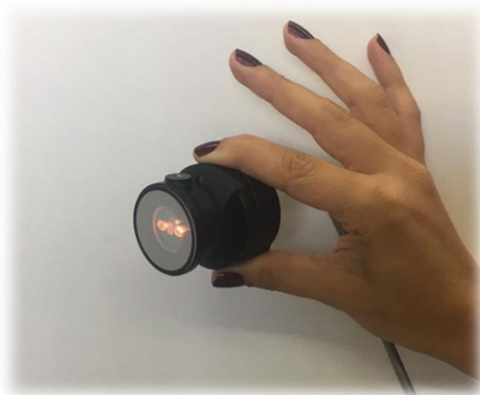
Figura 7. Espectrómetro portátil (MicroNIR™, VIAVI)
