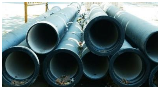
Figura 8 - Tuberías de fundición dúctil Fuente: EMASESA
